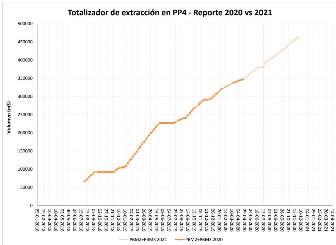
Figura 4. Comparación de la suma del totalizador de los pozos PBM2 y PBM3 (extracción en el entorno del pozo de observación PP4) entre el reporte 2020 y 2021.
