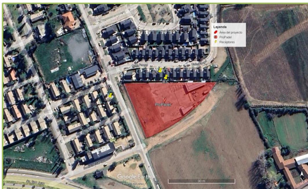
Figura 1: Ubicación de Receptores y Fuente para medición con respecto al IPT. Fuente: Google Earth; escala 90 m.
