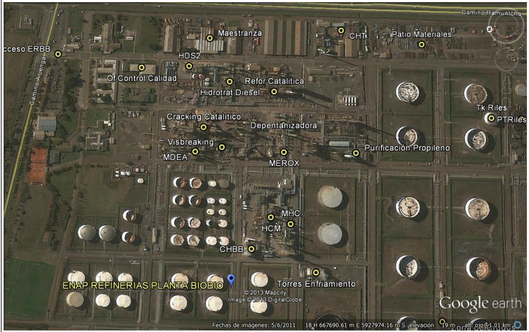
Figura N° Detalle distribución unidades ERBB – Sector Norte (elaboración propia) Fuente: Google Earth
