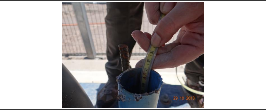
Fotografía 13 Fecha : 29 octubre 2013 Coordenadas WGS84 Norte: 7.393.425 Este: 562.467 Descripción Medio de Prueba: Medición del nivel freático del pozo Camar 2
