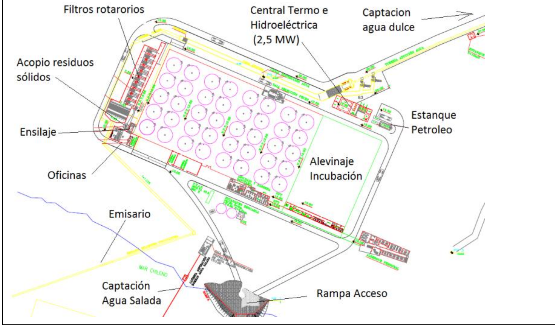
Figura . Layout del Proyecto (Fuente: Adaptación de diagrama contenido en DIA, RCA N°535/11)
