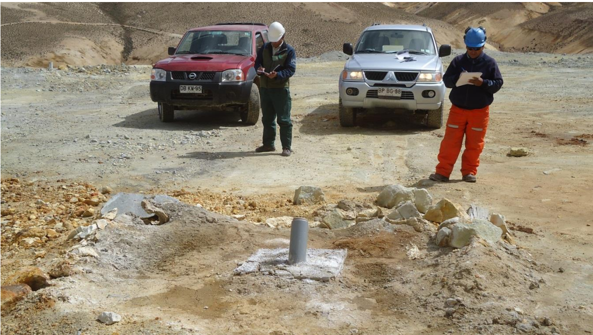
Foto 10 Inspección Sondaje 1, el lugar está limpio y sin residuos, el tubo está instalado con su correspondiente tapa.
