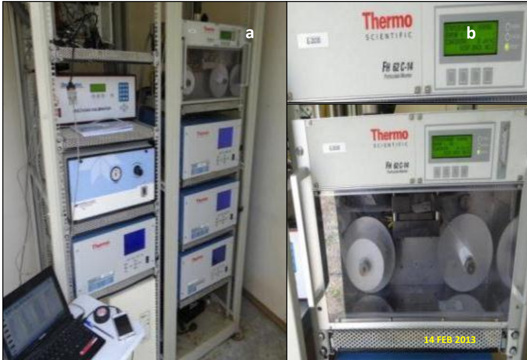
Fotografía 10. Estación Lota Rural. A) Rack monitor MP10 y analizadores de gases. B) Equipo MP10 reporta error, concentración cero.
