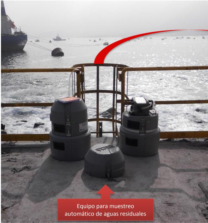
Equipo para muestreo automático de aguas residuales
