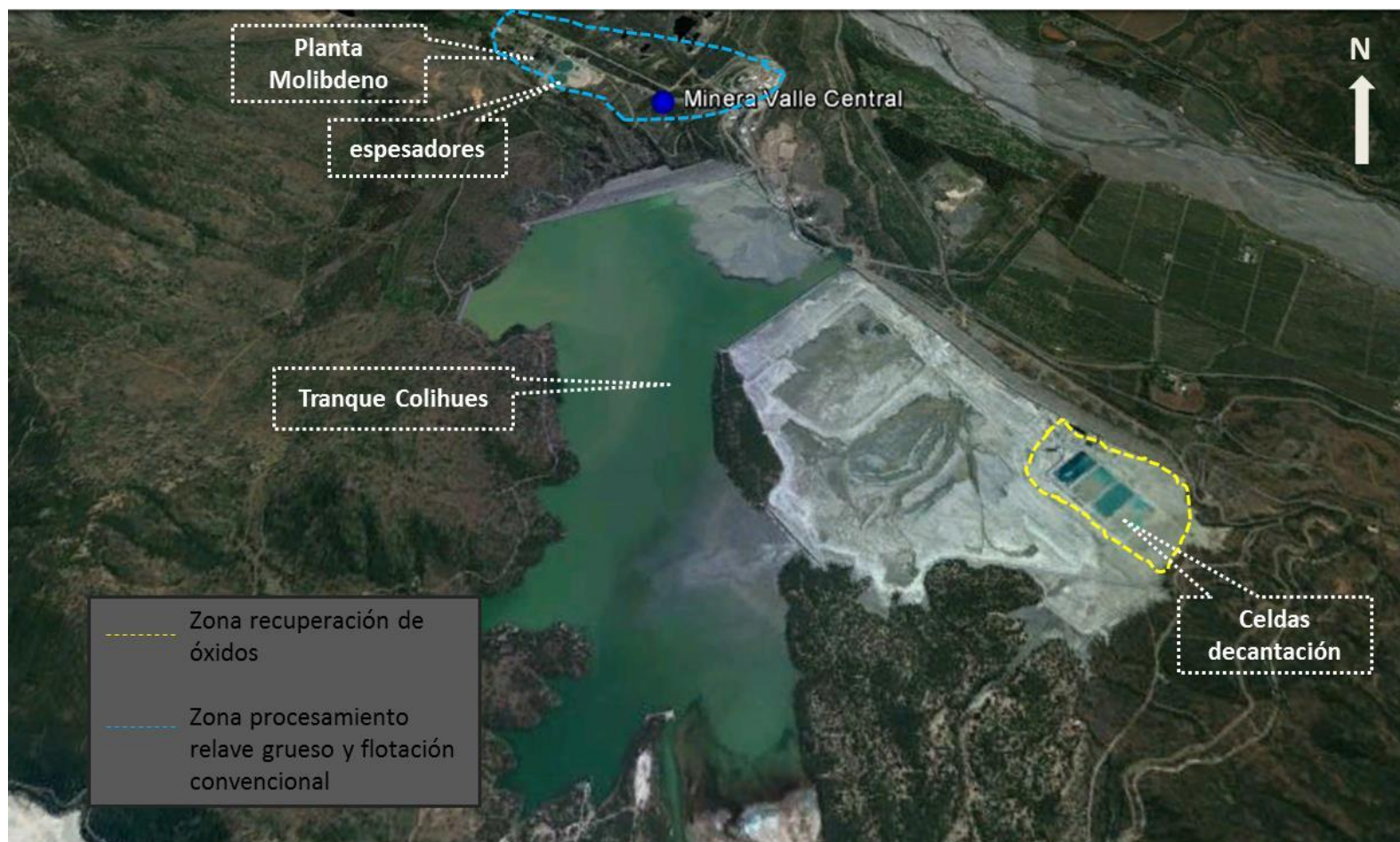
Figura . Layout de la Instalación “Minera Valle Central”: (Fuente: Google Earth, 2013; elaboración propia).
