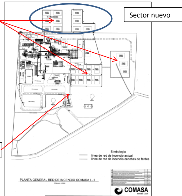
Figura 6. Plano de red de incendio presentada por el titular del proyecto el día 21/02/2014.
