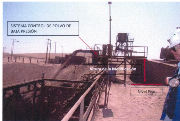
Chancador Primario Propio, modificado tolva de recepción.
