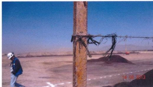
Sistema de control para la altura de las pilas de óxido de lixiviación, a 1.80 metros.
