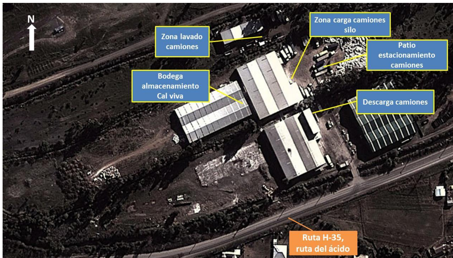
Figura 3. Layout de la Instalación “Cal Viva 7 puentes”: (Fuente: Google Earth, 2013; elaboración propia).
