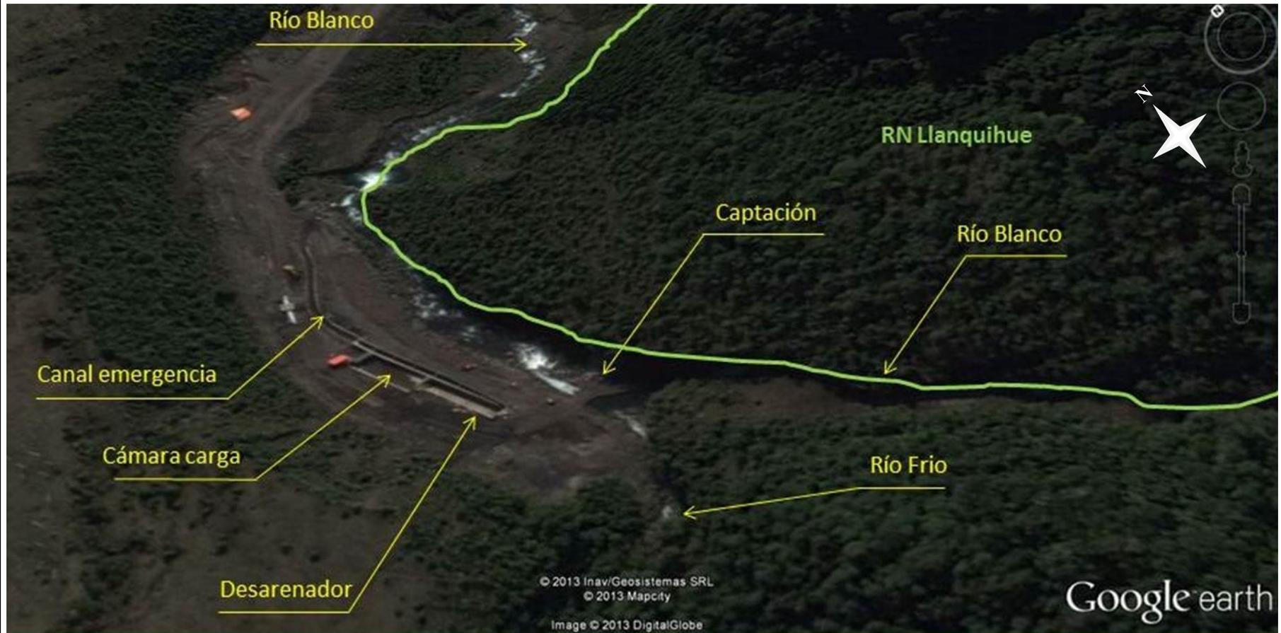
Figura N° . Distribución espacial de instalaciones en sector sala de máquinas y restitución (Fuente Google Earth):
