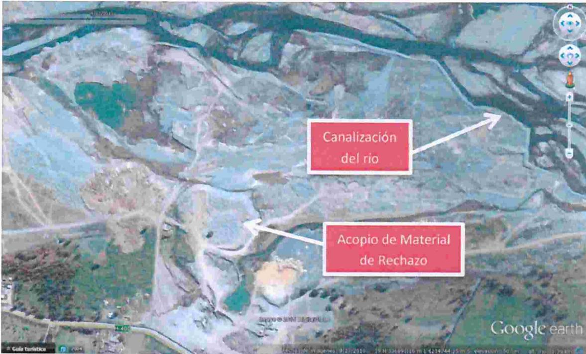
14.3. En el año 2013, se aprecia de forma más marcada el canalón inducido artificialmente, la erosión producida en el sector y las faenas de extracción cercanas a defensas fluviales construidas, en conjunto con espigones sumergidos, tal como se expone a través de la imagen que se inserta a continuación.
