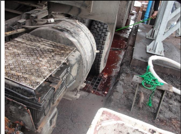
Figura N° 17: Residuos líquidos que escurren desde la tolva del camión que recibía los escobajos hasta alcantarilla del sistema de evacuación de aguas lluvias con descarga al Estero Carretón.
