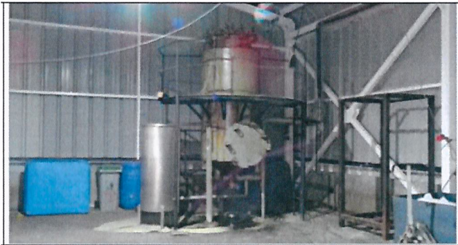
Fotografía 8. Fecha : 25-02-2016 Descripción medio de prueba: Vista del cocedor de vapor directo, para el tratamiento de vísceras y residuos sólidos.
