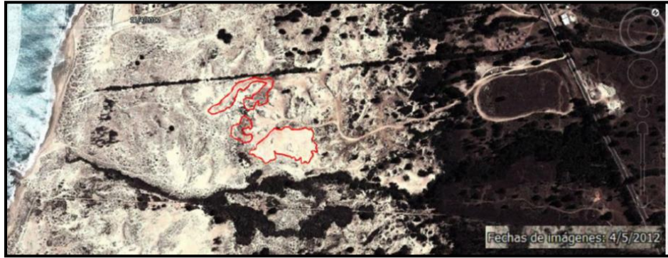
Imagen N°3: Fundo Santa Margarita, 5 de abril de 2012. En color rojo se identifican las superficies intervenidas por extracción de áridos, por un total de 2,2 ha. Fuente: DFZ-2018-2494-V-SRCA, pg. 16.
