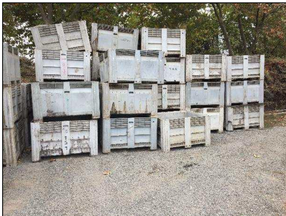
Imagen N° 2. acopio de bins con lodos y bins vacíos, a un costado de la planta de tratamiento de Riles, sin tapa y ubicados en suelo maicillo
