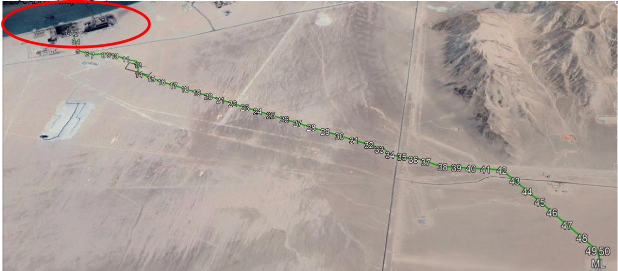
Fuente: Archivo KMZ de la Línea de Transmisión Eléctrica del STMC presentado por la Empresa. En círculo rojo, se ha identificado la subestación eléctrica Mejillones desde donde se inicia la línea de transmisión desde torres 1 a 50.
