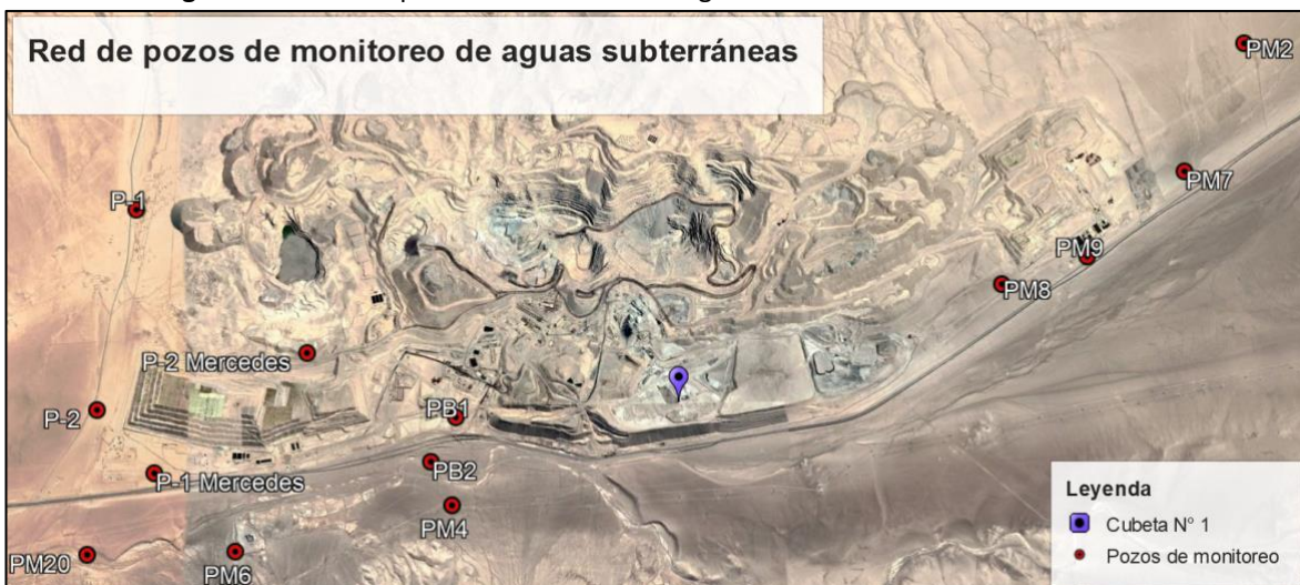
Figura N° 4. Red de pozos de monitoreo de aguas subterráneas de Mantos Blancos
