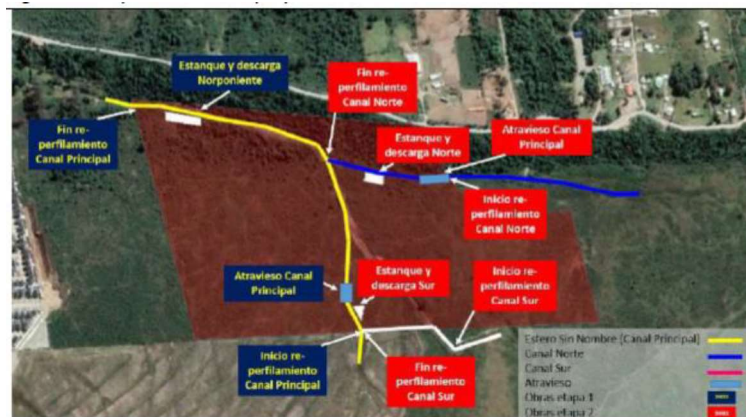
Imagen 24. Esquema situación proyectada de modificación de cauce Humedal Valle Volcanes
