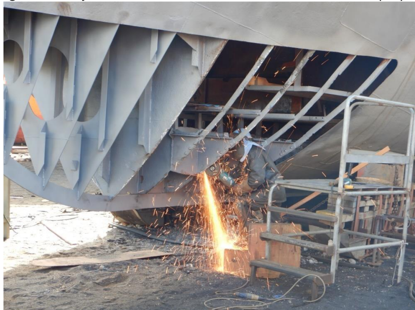
Imagen 4. Trabajos de corte efectuados en una embarcación en el proyecto.
