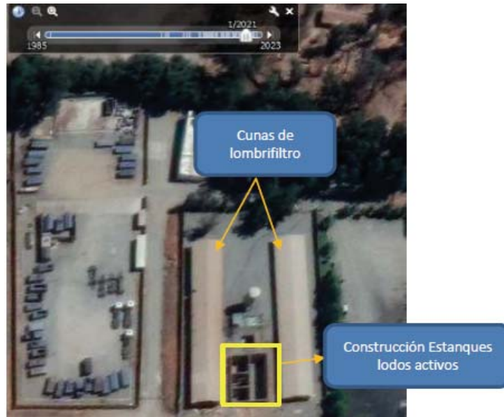
Figura N°10: Dos cunas del sistema Tohá, construcción del sistema de lodos activos sin líquidos en su interior, con fecha de enero de 2021.
