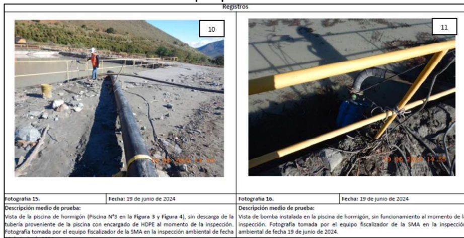
Figura 8. Piscina colectora N°3 con bomba de impulsión instalada a raíz del evento de precipitaciones
