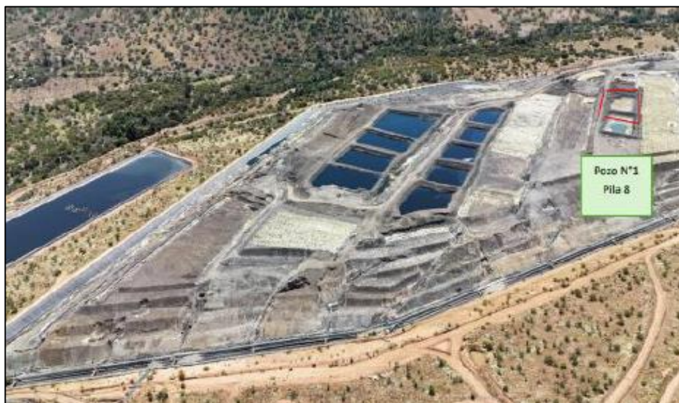
Imagen 4. Pozos de acumulación sobre pilas de lixiviación
