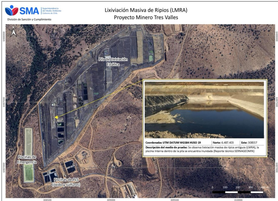
Imagen 2. Pozos de acumulación, correspondiente a la lixiviación masiva de ripios
