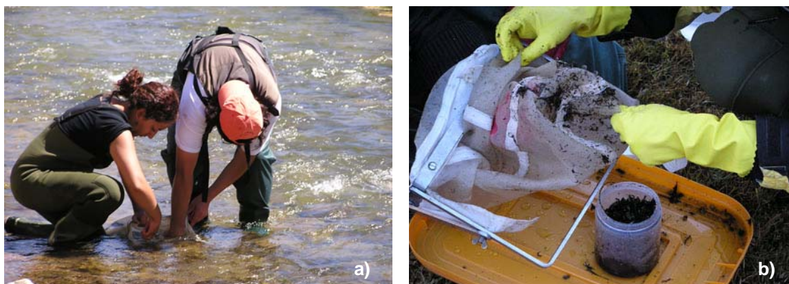
Figura 3.3. Metodología utilizada en el muestreo de macroinvertebrados. a) Toma de la muestra, b) Muestreador (Red Surber).
