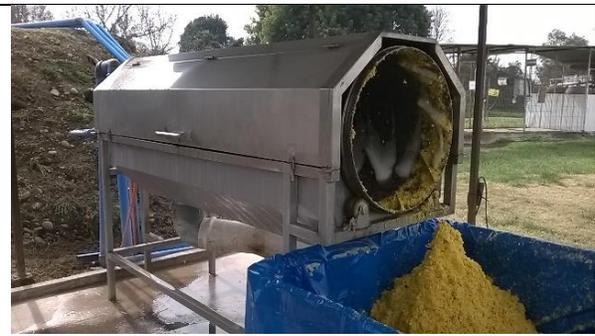
**Fig. 4 - Equipo de Filtración Rotatorio Actual**
