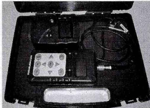
**Vibrómetro ACO Type 3233, tipo 1**, para monitoreo y análisis de vibraciones ambientales, rango de frecuencias 1 a 200 [Hz].
