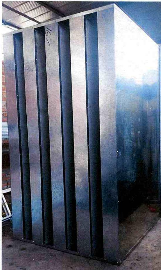
**Figura 3. Silenciador Splitter típico.**
