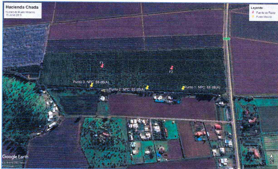
Figura 1 – Ubicación fuentes de ruido y puntos de medición considerados en las mediciones de ruido y el NPC en dB(A).
