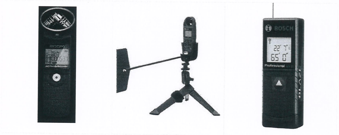
Figura 1 Estación de monitoreo de ruido y condiciones meteorológicas (conexión en tiempo real bluetooth).
