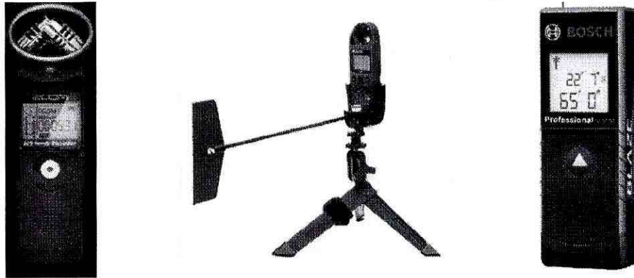
Figura 1 Estación de monitoreo de ruido y condiciones meteorológicas (conexión en tiempo real bluetooth).
