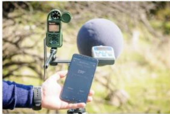
Figura 1 Estación de monitoreo de ruido y condiciones meteorológicas (conexión en tiempo real bluetooth).
