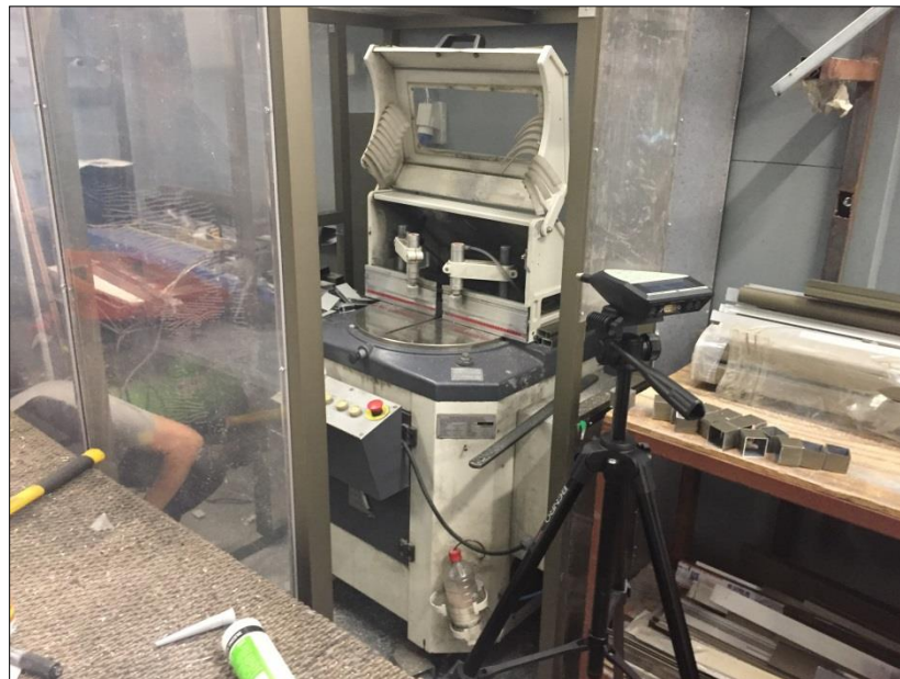
Figura 3. Medición del ruido generado por cortadora de perfiles.
