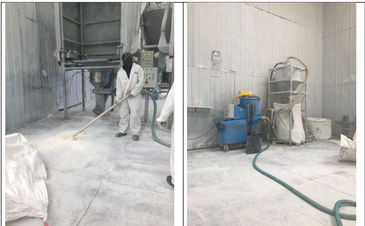
Figura 3-4 Izq: Aspirado de área una vez finalizada la descarga de maxisaca. Der: Sistema de aspirado.
