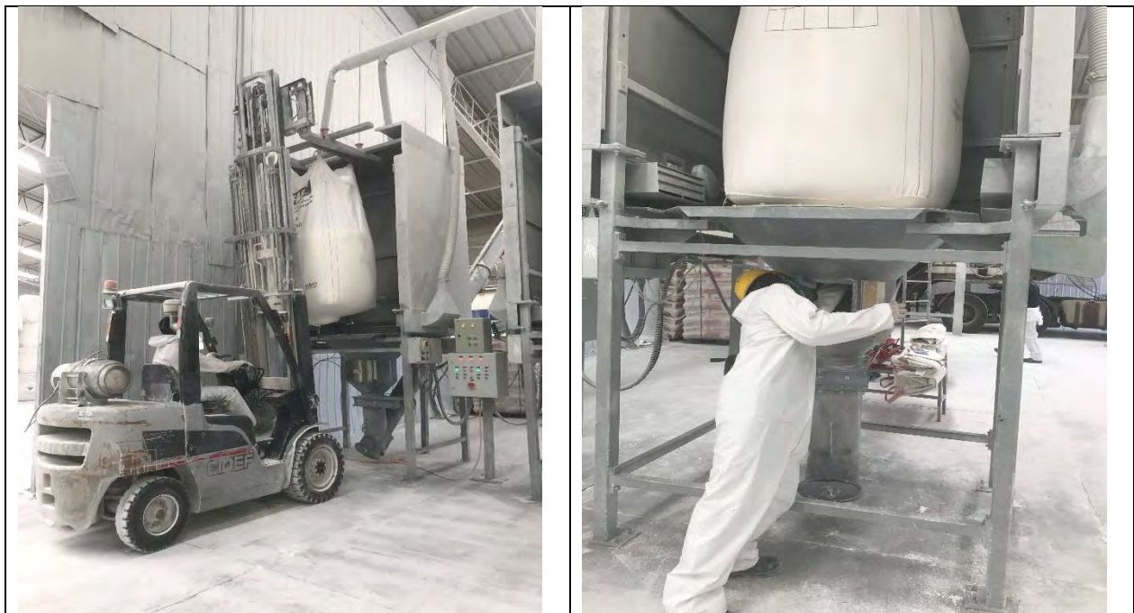
Figura 3-2 Izq: Posicionamiento de maxisaca. Der: Inicio de descarga a través de escotilla.
