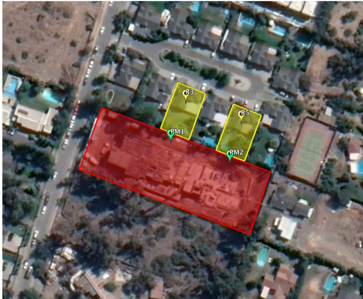
Figura 3.1. En rojo se indica el terreno de las obras del edificio Vista Valle. En amarillo los receptores evaluados y en verde los puntos de medición.
