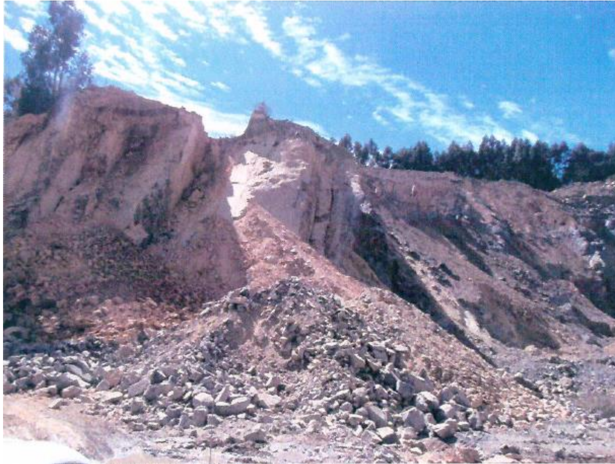
Foto proporcionada por SERNAGEOMIN: Imagen muestra ángulo inverso del talud del área de extracción
