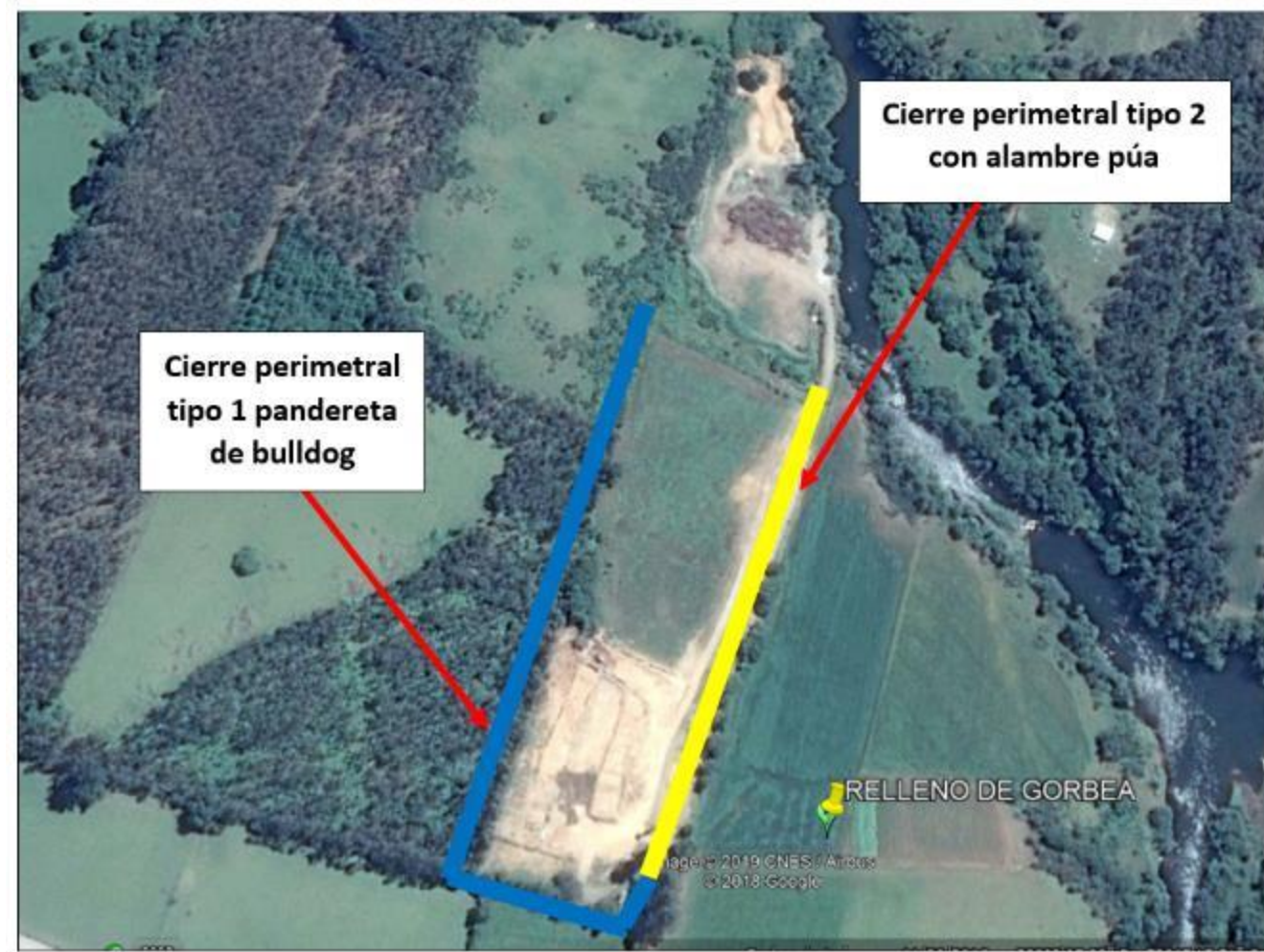
Imagen. Cierre perimetral vertedero de Gorbea.
