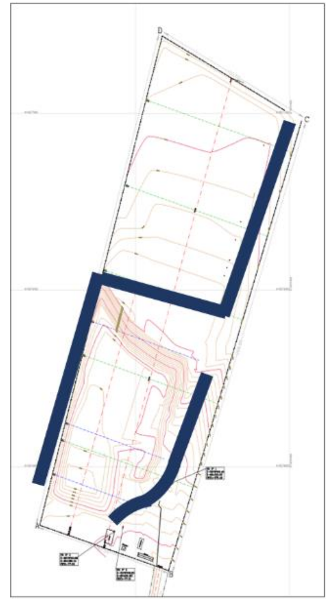
Imagen. Canalización de aguas lluvias
