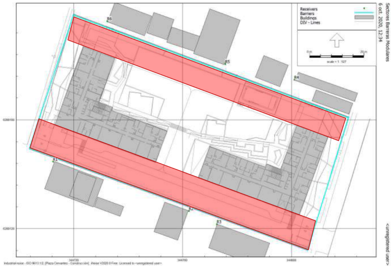
FIGURA 10. SECTORES DONDE SE UBICARÁN BARRERAS ACÚSTICAS MODULARES.
