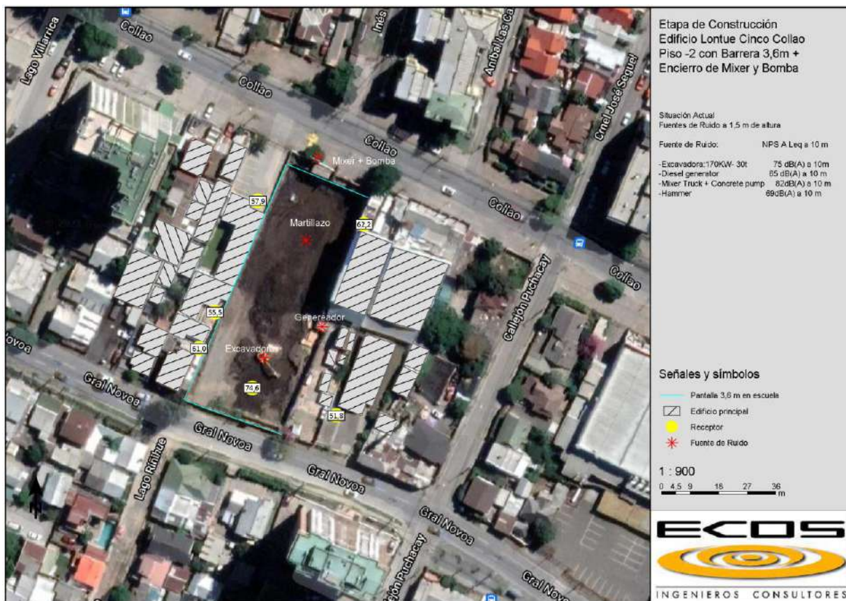
Fig 7. Resultados con medicdas de control. Barrera acústica de 3,6 m más semi encierro Míxer y Bomba Pluma de Hormigón.
