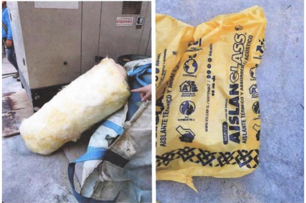
La lana mineral usada es Aislam Glass de 50mm
