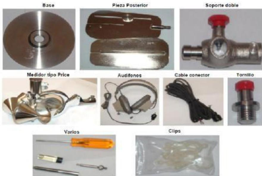
Figura N°A.2: Componentes del molinete.
