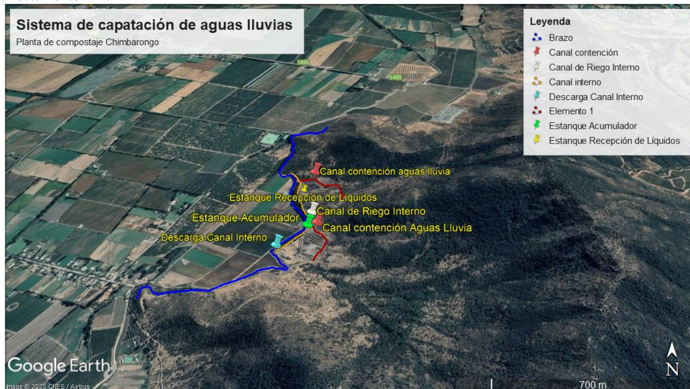
Imagen N°7: Sistema de captación de aguas lluvias
