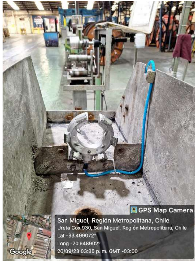
Ilustración 18. Secador canoa de enfriamiento máquina 300
