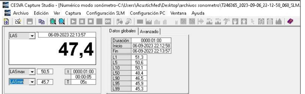
Las siguientes imágenes demuestran los niveles de presión sonora NPSEQ MIN, MAX, medidos con un sonómetro de clase 2 calibrado en terreno en un receptor a 130 metros.
