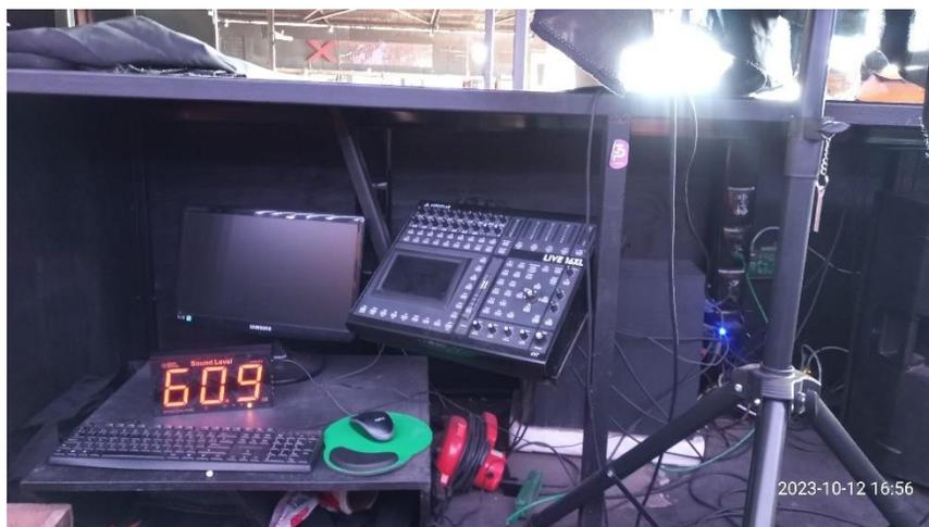
Imagen 8, Medidor de nivel de presión sonora implementado en sala DJ Escenario 2, Terra
