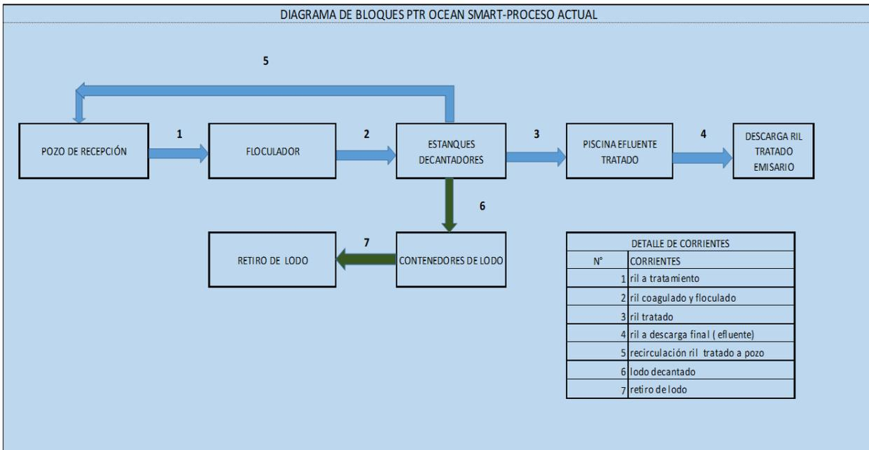
Fig. Nº 2: Diagrama PTA actual y en funcionamiento.
