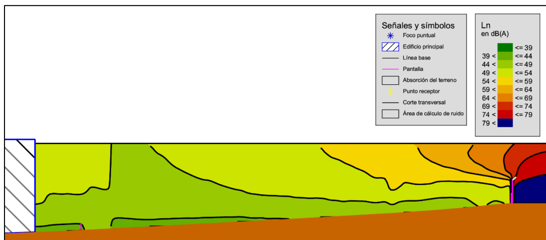
Figura 9. Corte transversal de la emisión de ruido con solución acústica implementada.
