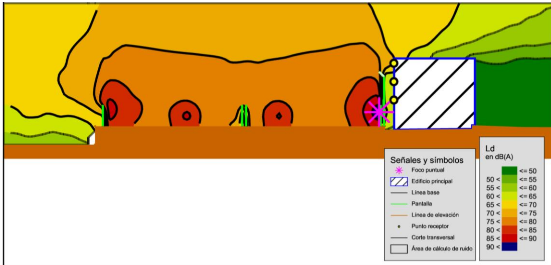
Figura 11. Corte transversal correspondiente al uso de pantalla acústica de 7+1 m de altura.
