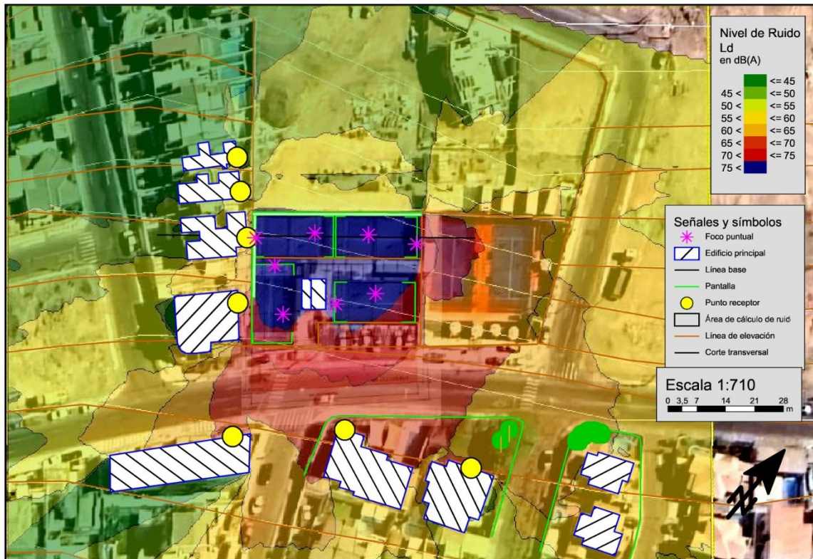
Figura 10. Mapa de ruido a una altura de 6 m, con pantalla acústica de 7 +1 m de altura en costados suroeste y oeste.
