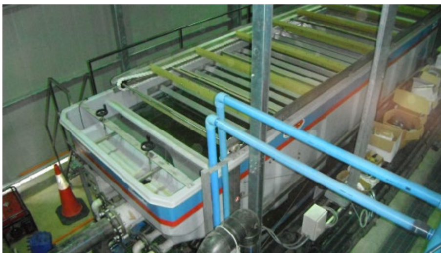
Fotografía 3: Equipo DAF de la planta de tratamiento de RILes de Planta Verde
