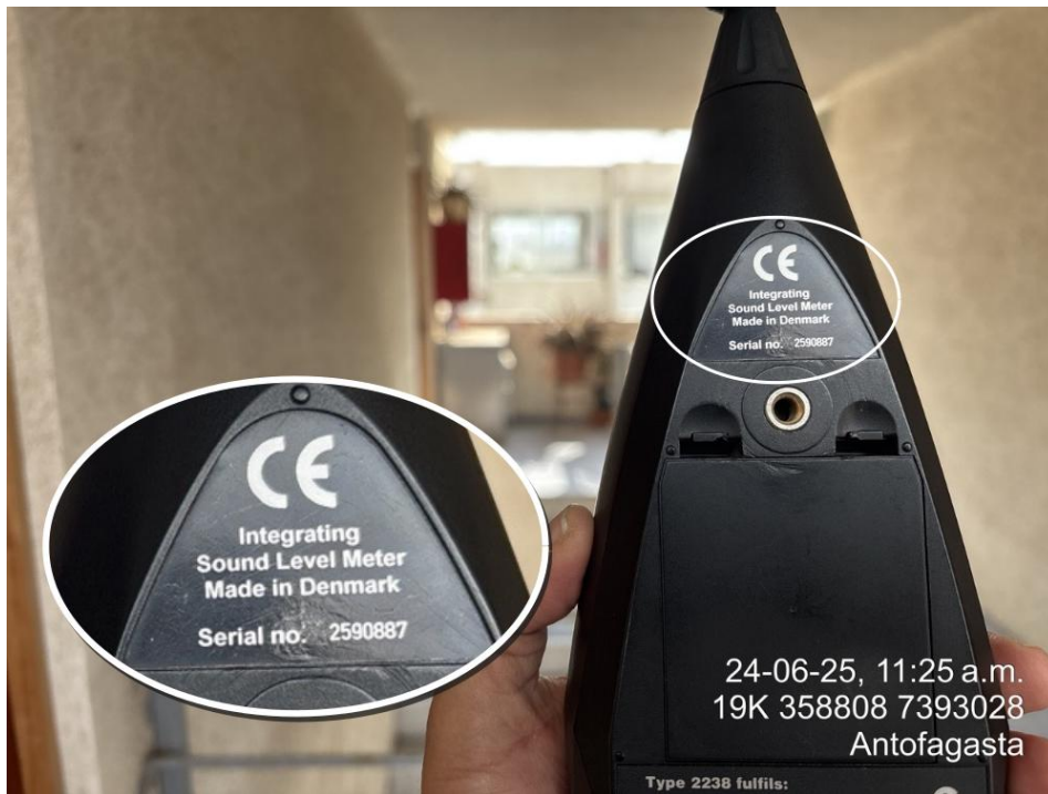
Figura 1. Sonómetro utilizado en monitoreo de ruido, Brüel & Kjaer 2238.
